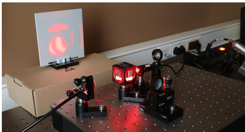
Rys. 6. Interferometr i prążki dla czerwonej diody LED o drodze spójności światła około 10\ \mu\text{m} (foto: Krzysztof Magda)
