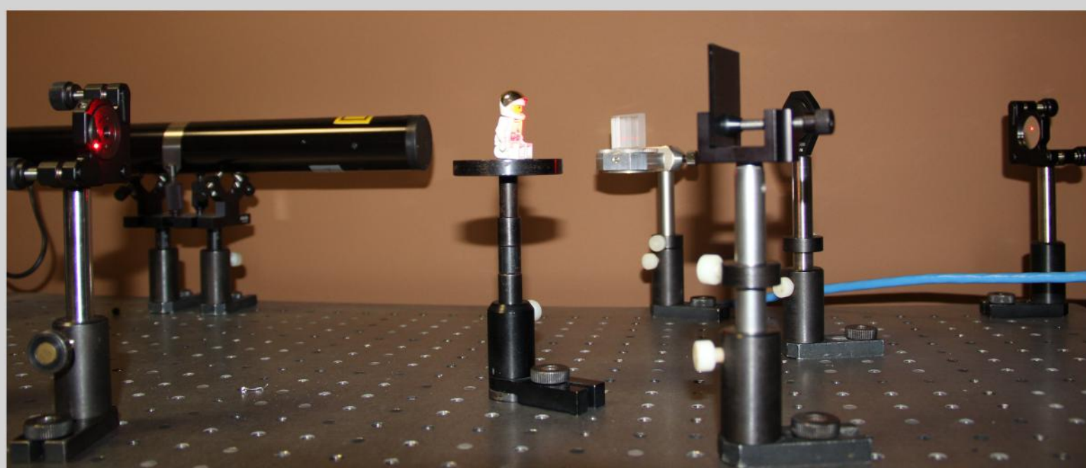
Rysunek 1: Rejestracja hologramu metodą Leitha-Upatnieksa.
