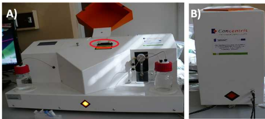
Rysunek 1: Układ badawczy Cantisens ® CSR-801. A – główny moduł badawczy, czerwonym owalem zaznaczono miejsce na włożenie podstawki z zestawem beleczek. B – jednostka sterująca.
