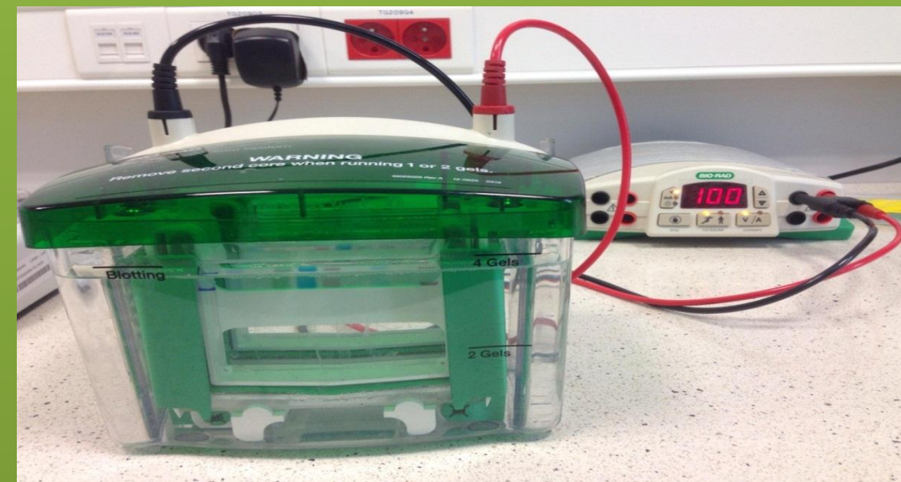
Rys.1: Zdjęcie żeli wraz z próbkami w komorze do przeprowadzania rozdzielu elektroforetycznego podczas trwania elektroforezy.
