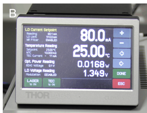
Rysunek 5. A. Zależność mocy optycznej diody laserowej (Thorlabs model BL976-SAG) od prądu zasilania. Pomiar mocy optycznej wykonano na wyjściu układu kolimacyjnego tzn. za soczewką S1. Prąd progowy powyżej którego zachodzi akcja laserowa wynosi 50 mA. Dane należy traktować wyłącznie orientacyjnie. B. Panel czołowy sterownika diody laserowej firmy Thorlabs.
