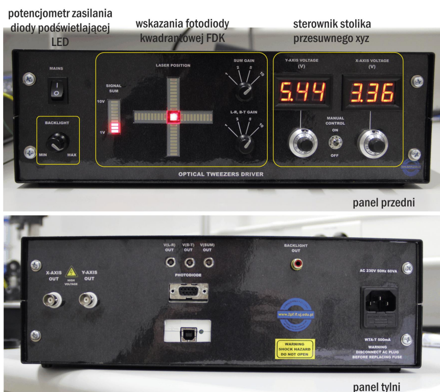
Rysunek 6. Sterownik stolika przesuwego xy wraz z regulatorem oświetlenia z diody LED oraz układ wskazań sygnałów napięciowych z fotodiody kwadrantowej FDK.
