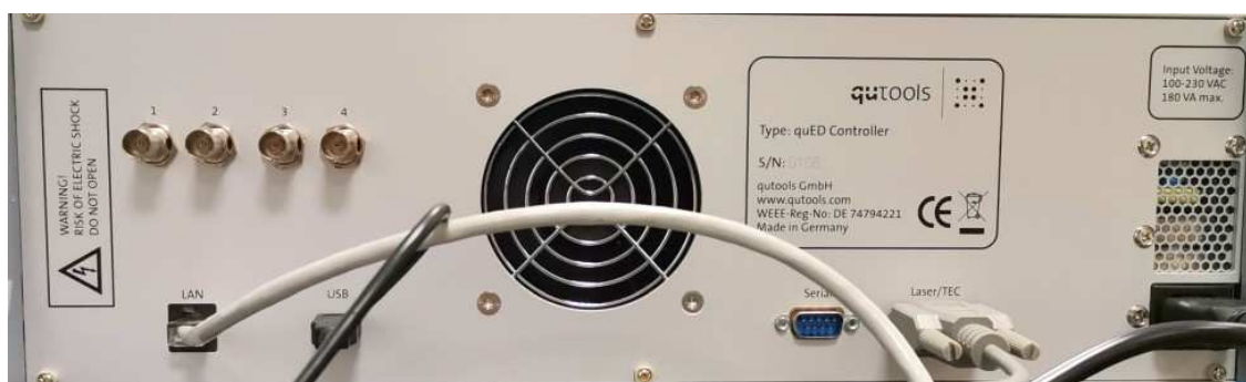
Rys. 12. Panel tylny sterownika „Entanglement Demonstrator”. Do gniazda USB podłączony jest koncentrator (hub) tego portu, umożliwiający jednoczesne sterowanie pozycjami polaryzatorów oraz zapis danych pomiarowych do pamięci USB FLASH podłączonej do koncentratora. Nie należy odłączać pamięci FLASH od portu USB podczas pracy sterownika (nie ma możliwości odłączenia tej pamięci programowo; jej wyjęcie z gniazda może spowodować utratę danych i błędny zapis w strukturze plików).
