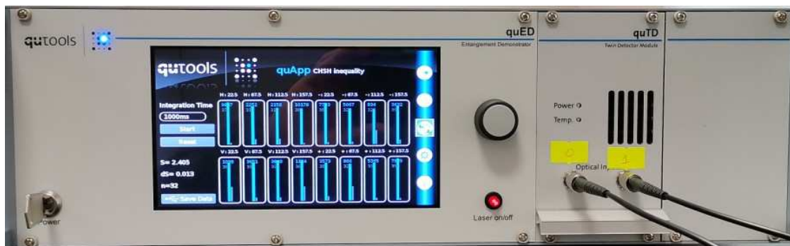
Rys. 11. Sterownik zestawu „Entanglement Demonstrator”; po prawej stronie ekranu dotykowego znajduje się gałka impulsatora służąca do zmiany parametrów pracy wybranych z menu ekranowego, a pod gałką impulsatora umieszczono czerwony przycisk włączający obwód diody laserowej; czerwone podświetlenie tego przycisku świadczy o pracy lasera!
