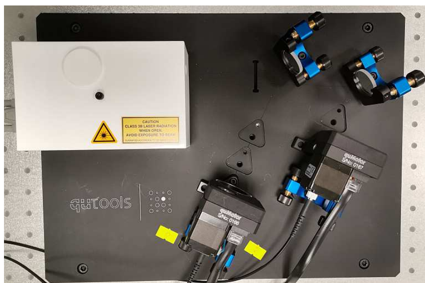
Rys. 14. Układ optyczny kierujący fotony 810 nm do wejść kolimatorów światłowodowych.
