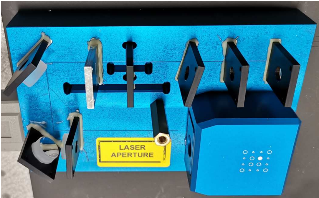
Rys. 7. Układ optyczny generatora par splątanych fotonów zastosowany w zestawie Entanglement Demonstrator .
