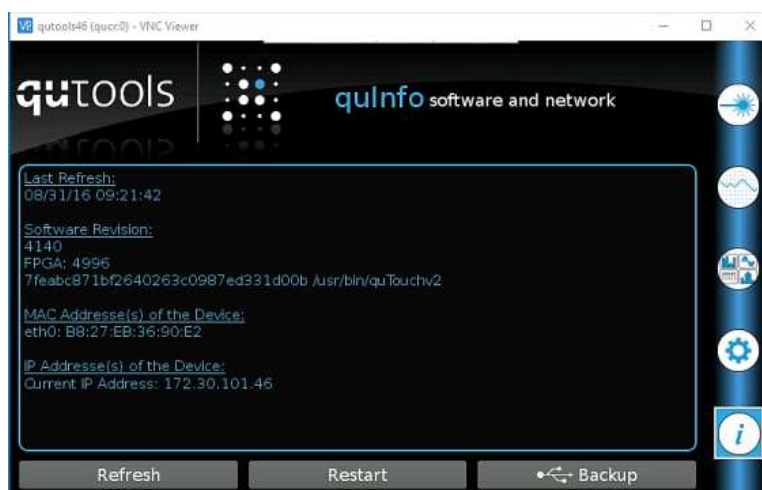
Rys. 13. Ekran dotykowy sterownika „Entanglement Demonstrator” w zakładce „i” pozwala sprawdzić przyznany dynamicznie adres IP. Podawany przez sterownik czas (i data) nie jest aktualizowany i należy o tym pamiętać analizując zarejestrowane (w pamięci FLASH) dane. Pozostaje liczyć na aktualizację oprogramowania, w której firma quTOOLS zwróci uwagę na ten problem!
