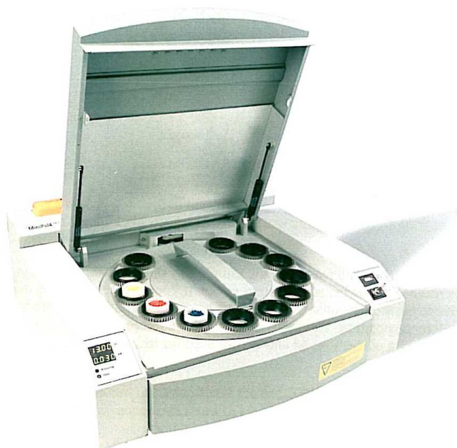
Rys. Używany spektrometr XRF (rys z dokumentacji PANalytical MiniPal4)
