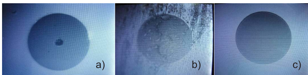
Rysunek 3: Obrazy mikroskopowe końcówek światłowodów: a) uszkodzona - światłowód wymaga wymiany, b) zabrudzona - wymaga wyczyszczenia, c) czysta.
