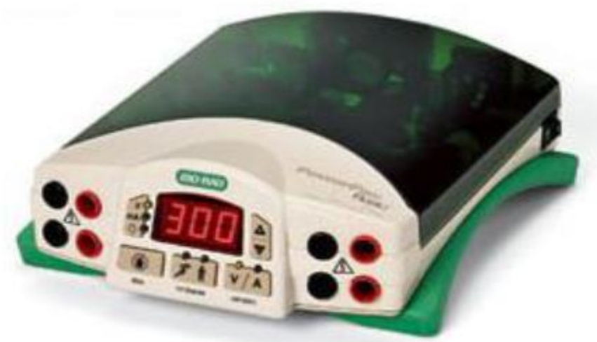
Rysunek 4. Zasilacz do zestawu do elektroforezy.
