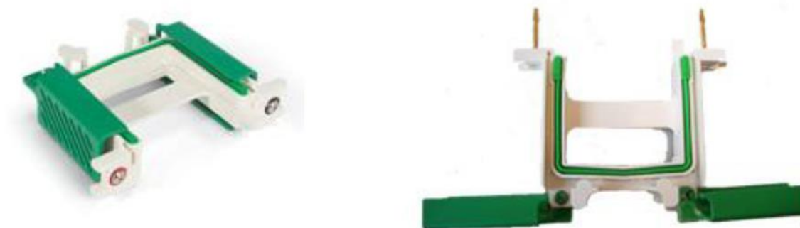
Rysunek 5. Kasetka z komory do umieszczania żeli.
