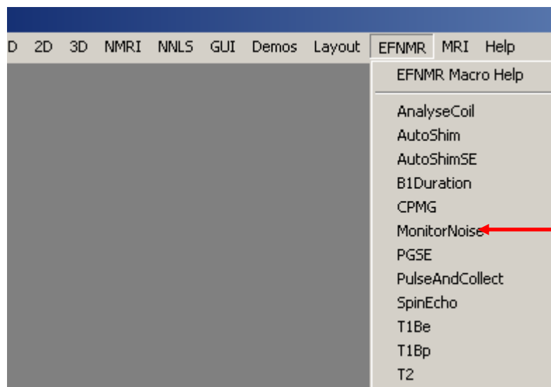
Rys. 6 Oprogramowanie konsoli Prospa , zakładka Earth Field Nuclear Magnetic Resonance (EFNMR) . Wybór procedury wykonującej pomiar poziomu szumów.
